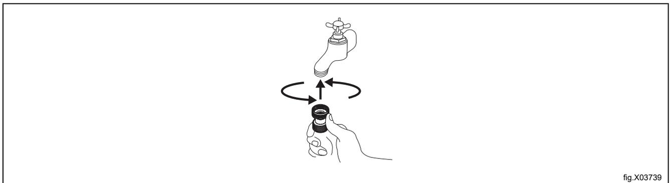
6. Schließen Sie das andere Ende des KALTWASSER-Zulaufschlauchs mit einem 3/4-Zoll-Gewinde an das Ventil des Kaltwasserhahns an.
