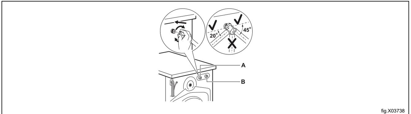
3. Bringen Sie die Schläuche passend zur Position des Wasserabsperrentils so an, dass sie schräg nach links oder rechts zeigen.
