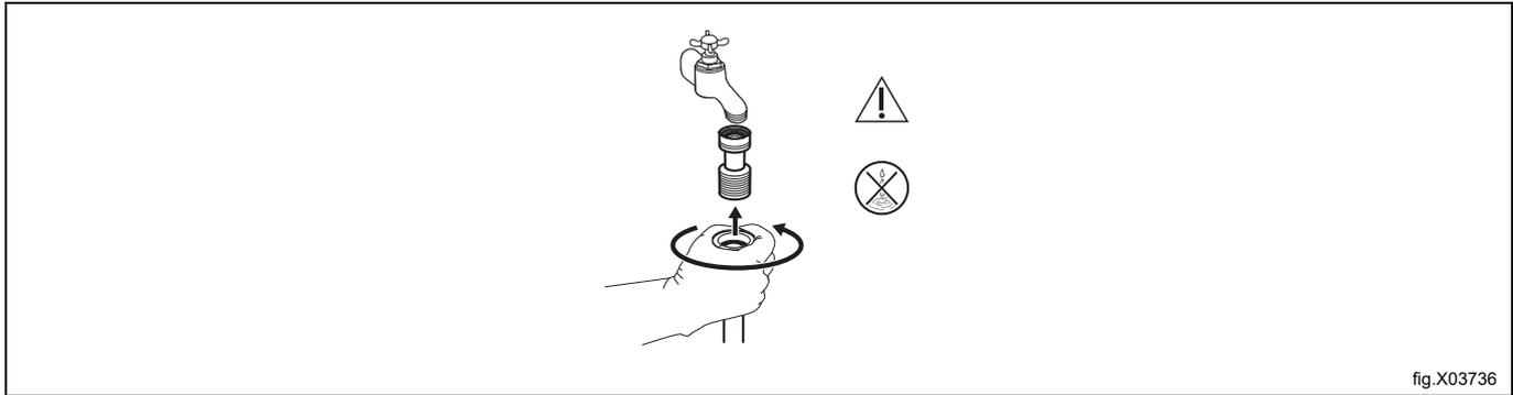
Anforderungen: 3/4-Zoll-Gewinde. Die Durchflussrichtung wird durch den Pfeil angezeigt.
